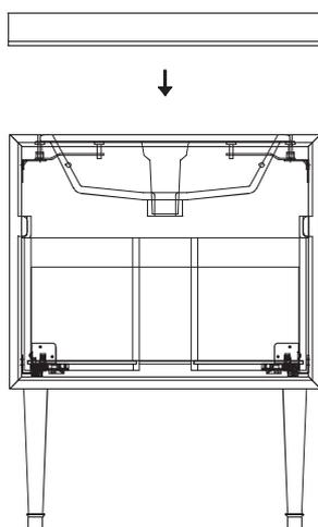
**6.** Posizionare il lavabo ceramico sulle viti di supporto regolando l'altezza in linea con il bordo superiore del mobile. Posizionare poi il top in vetro sulla superficie precedentemente siliconata.
