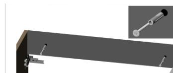
**3.** Riportare a parete i punti di posizionamento delle piastre per attaccaglia, scostare il mobile e fissare a muro le piastre mediante viti e tasselli a seconda della tipologia della parete. Riaccostare il mobile a parete e agganciare le attaccaglie alle piastre.
