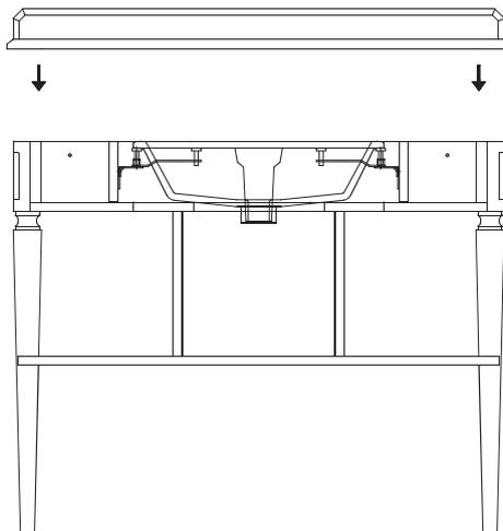
**5.** Posizionare il lavabo ceramico sulle viti di supporto regolando l'altezza in linea con il bordo superiore del mobile.
