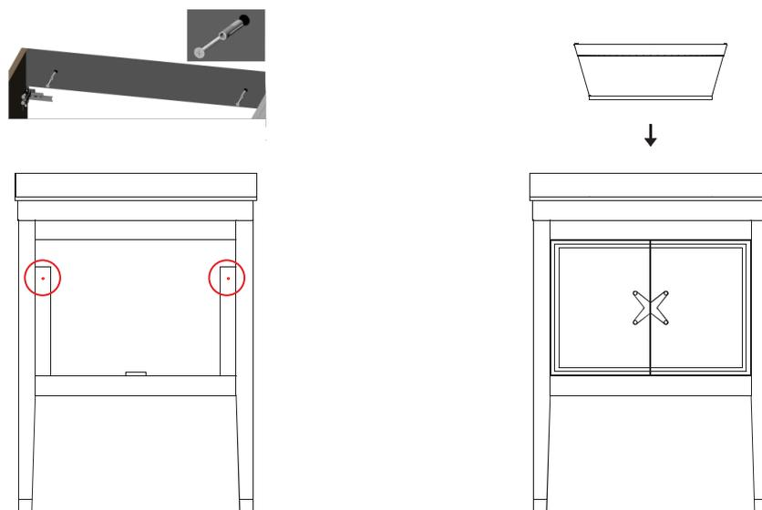
**1.** Procedere al fissaggio a parete attraverso i punti riportati nella schiena del mobile, mediante viti e tasselli a seconda della tipologia della parete.
