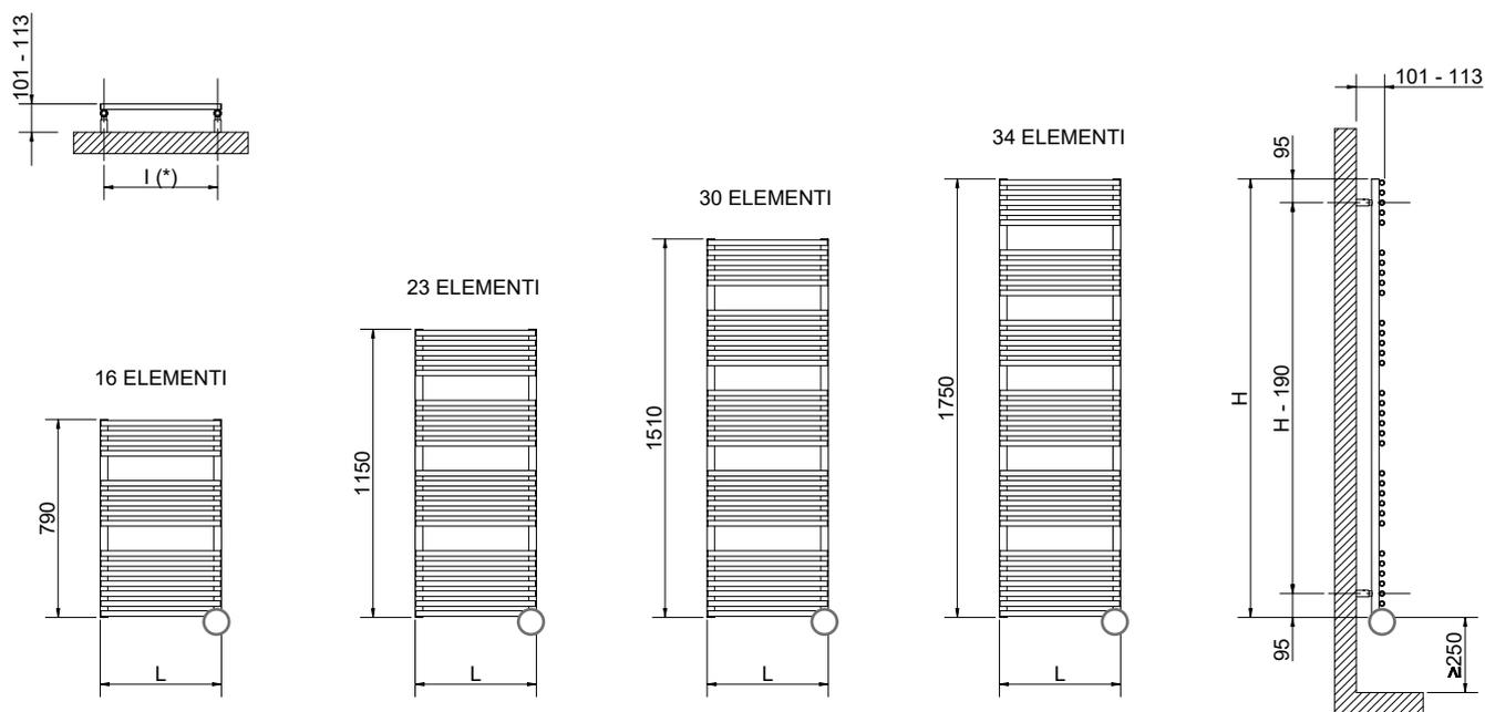
(\*) Misura dell'interasse (l) del kit di fissaggio
