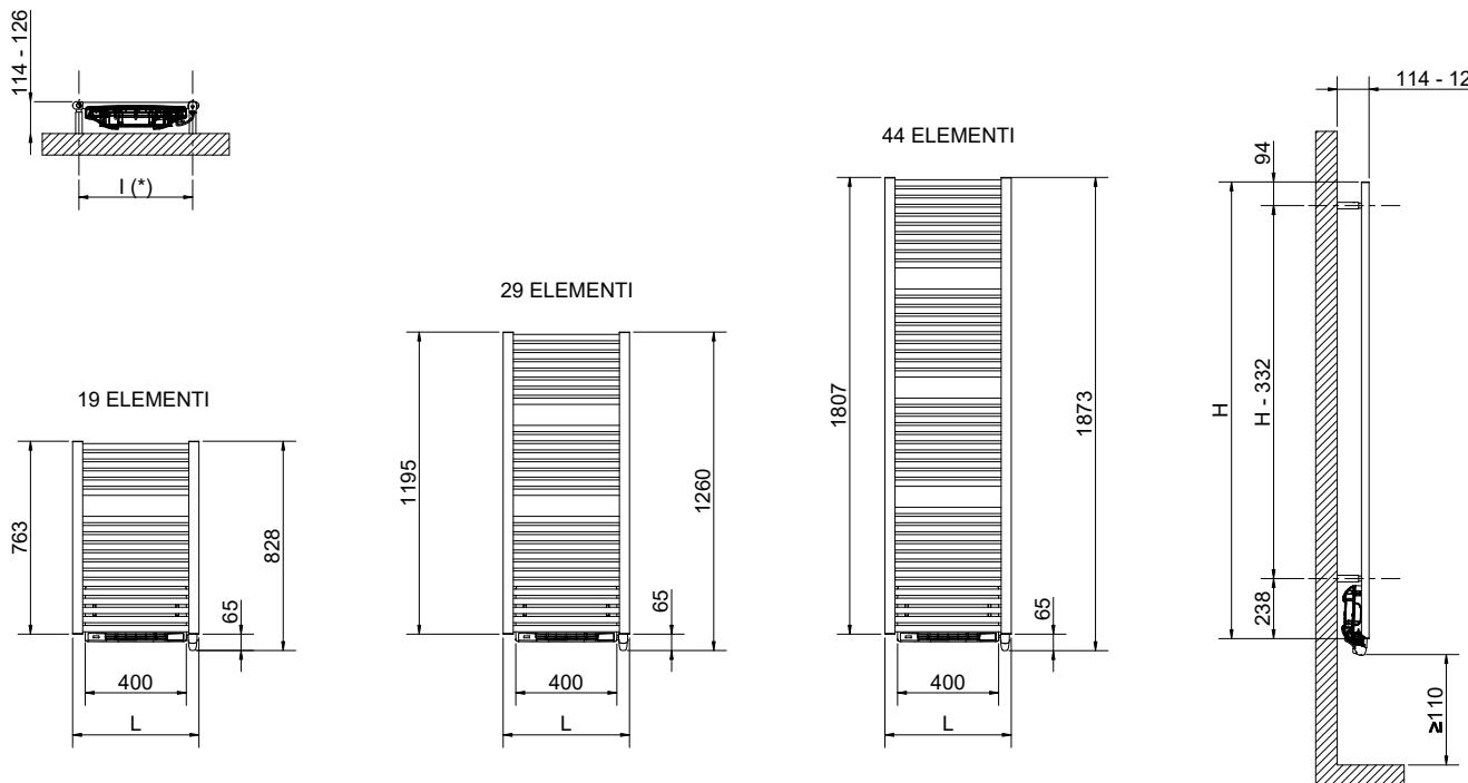
(\*) Misura dell'interasse (l) del kit di fissaggio
